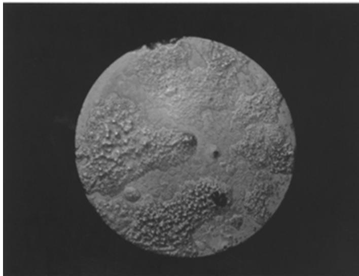
図 3.16 EX-B3 の信頼性試験 100 時間後のレンズ面観察結果
