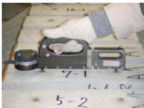
写真-3.3.5 作業風景 乾燥収縮ひずみの測定
