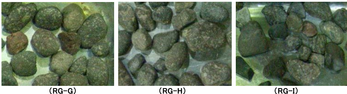
写真-3.3.3 モルタル除去後の再生粗骨材の外観
