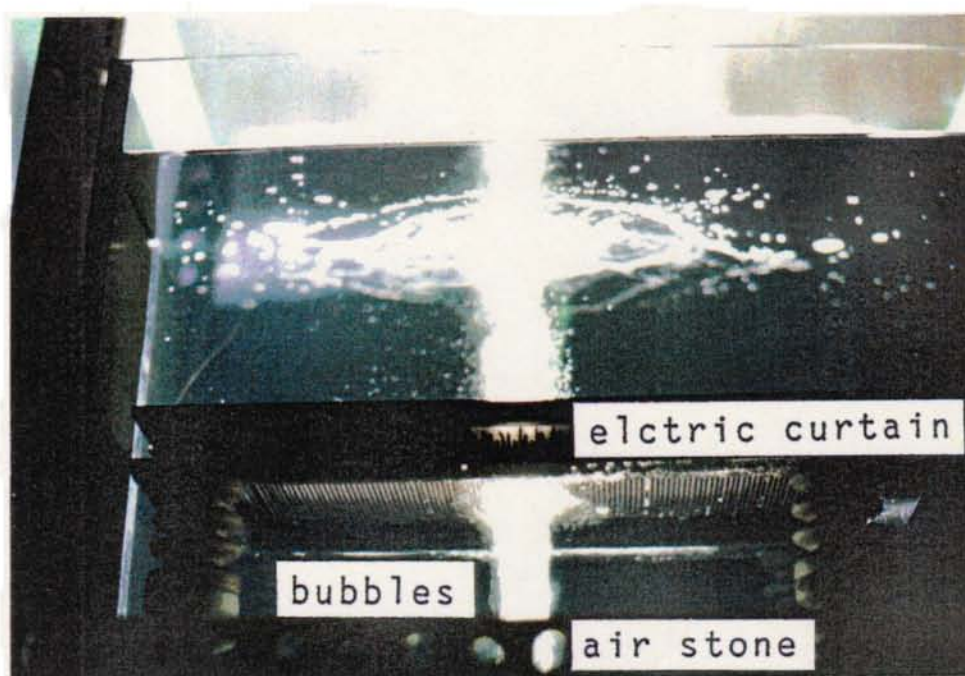
図4.4 浮力によって上昇する気泡が電極の隙間からすり抜けている 電極の隙間：0.5mm，気泡の直径0.2mm (無電圧)
