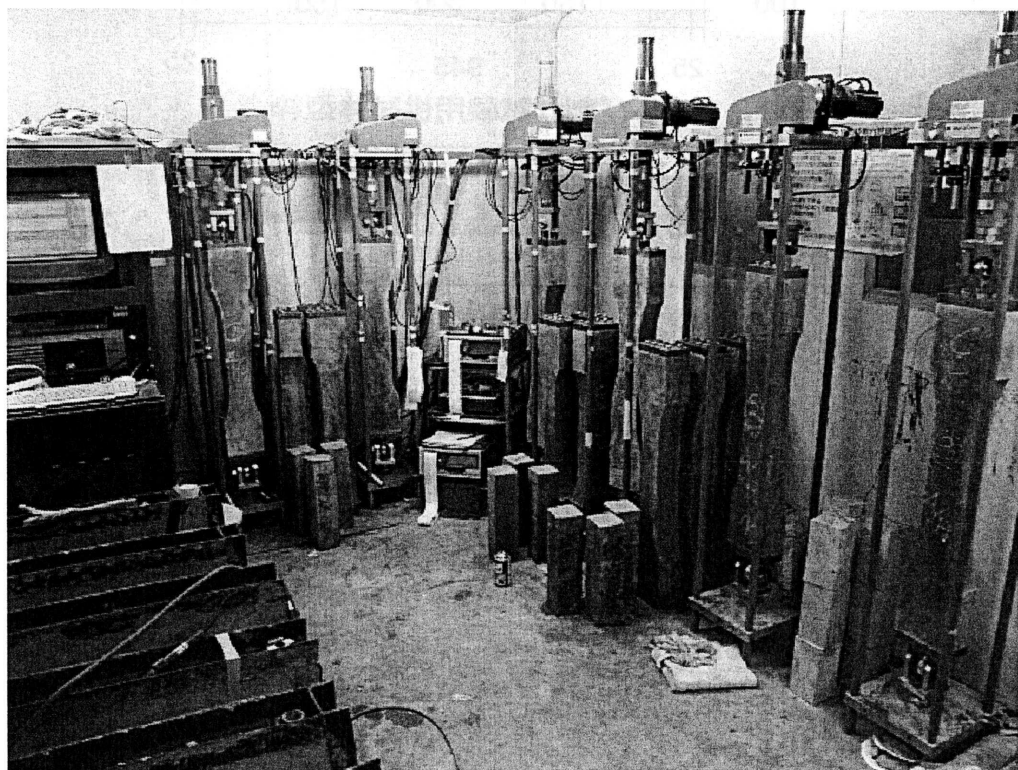
図-3.3.2 乾燥収縮ひび割れ実験状況
