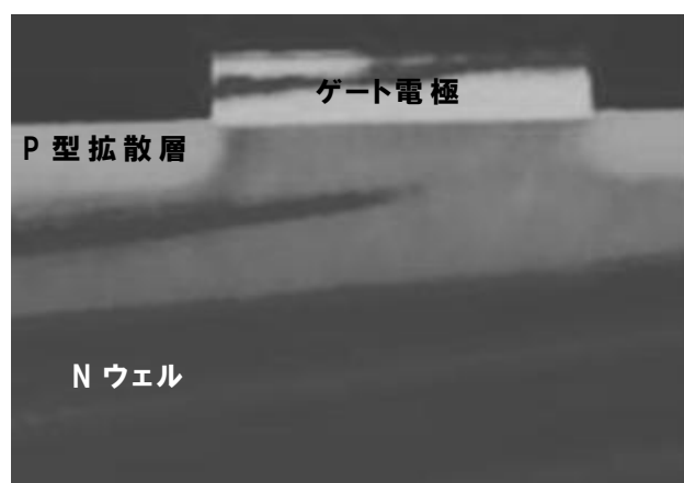
図 2-37 P型トランジスタ部の SSRM 測定例
