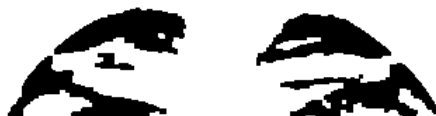
図 3.7 図 3.6 の画像における値 1 の画素の連結成分を求めた後、面積が閾値以下の連結成分を削除して得られる画像
