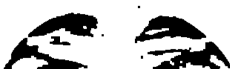
図 3.6 図 3.5 の画像に対して 3 \times 3 サイズの opening, closing 処理を適用して得られる画像
